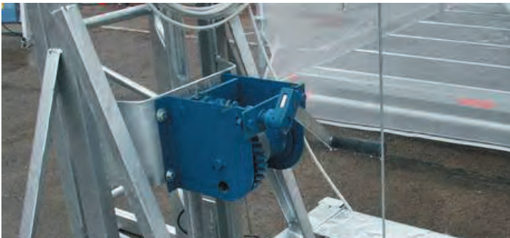
Treuil de montage avec grande démultiplication.
