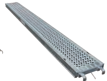
plancher acier de 2,5/3 m x 0,30 classe 4 (300 kg/m 2 )
